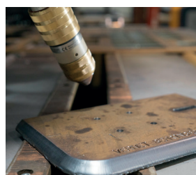
Découpe chanfrein avec tête 3D 3D chamfering cutting 3D Anfasenschnitt
