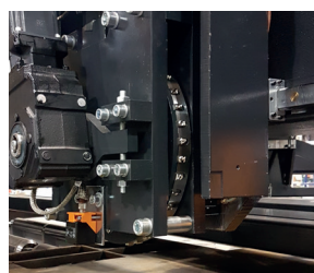
Marqueuse disque Disc marking unit Typenrad-Markiereinheit
