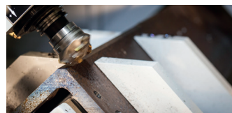
Ecrétagne haute vitesse High speed heel milling Hochgeschwindigkeits-Kantenfräsen
