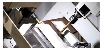
Unités de perçage au-dessus de la cornière : évacuation aisée des copeaux et du lubrifiant - Drill units above the angle: easy collection of chips and coolant - Bohreinheiten über dem Winkelprofil: einfache Späne- und Kühlmittelabfuhr
